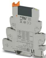
PLC-INTERFACE, bestehend aus Grundklemme PLC-BSC.../21 mit Schraubanschluss und steckbarem Miniatur-Solid-State-Relais, zur Montage auf Tragschiene NS 35/7,5, 1 Schließer, Eingang: 24 V DC, Ausgang: 3-48 V DC/100 mA
