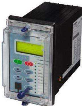
ARGUS 过电流继电器 非定向, 4 号模制 外壳, 4 个电路, 10 个 LED, 6 个二进制输入/6 个二进制输出 测量输入: 1/5 A, 50/60 Hz, 带 SEF 输入 辅助电压: 24 到 60 V DC, 二进制输入阈值 19 V DC 标准版本 - 无外盖 通信: 前端口: USB 和背面: RS485 支持 IEC 60870-5-103 或 Modbus RTU 或 DNP 3.0。前面板: 带断路器控制按钮 保护功能: 标准 版本
