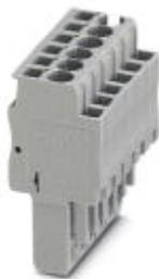
Stecker, Anschlussart: Zugfederanschluss, Steckanschluss, Anzahl der Anschlüsse: 9, Polzahl: 9, Querschnitt: 0,08 mm<sup>2</sup> - 4 mm<sup>2</sup>, AWG: 28 - 12, Breite: 46,8 mm, Höhe: 39 mm, Farbe: grau
