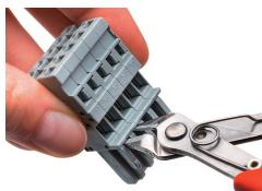
Codage d'un connecteur femelle – Enlever la(s) tige(s) de codage à l'aide d'un outil coupant Ni la 1ère ni la dernière tige de codage, elles servent à la fixation.
