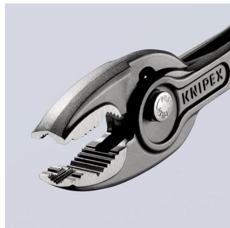
Komfortabel und zuverlässig: Der Druckknopf erlaubt die Einstellung der Greifweite in fünf Schritten direkt am Werkstück und rastet dann sicher ein – keine unbeabsichtigte Verstellung!
