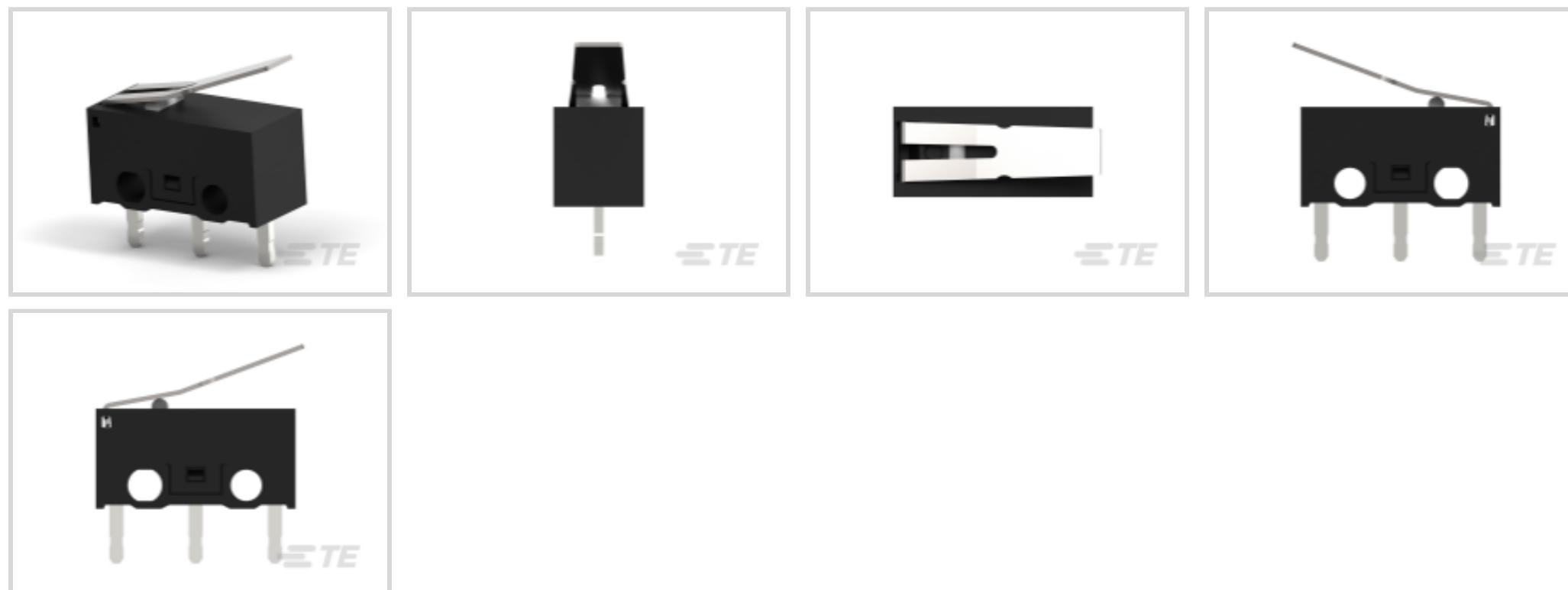
構成 (Pole-Throw): **単極 - 双投**アクチュエータのスタイル: **レバー**スナップアクションスイッチ端子の定格電流: **1.5 A, 3 A**スナップアクションスイッチの定格電圧: **125 VAC, 250 VAC**操作力: **26 g [.9 oz]**
