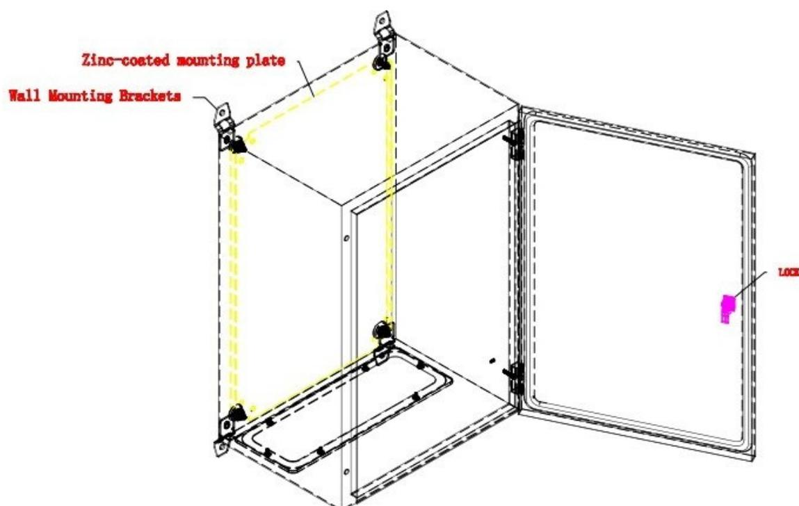
**Anwendung:** Industrieller Wandanschlusskasten aus Weichstahl gemäß IP66, geeignet für die Unterbringung von elektronischen und elektrischen Geräten in anspruchsvollen Umgebungen mit häufigem Abspritzen oder allgemein nassen Bedingungen.
