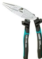
**Spizzange**, abgewinkelte Form, mit Öffnungsfeder und Arretierung, feingeschähte Greiffläche, Abisolermöglichkeit für 1,5 mm<sup>2</sup> und 2,5 mm<sup>2</sup>, integrierter Ringschlüssel M8 - M10, VDE 1000 V AC/1500 V DC geprüft
