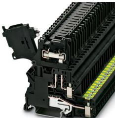
保险丝接线端子，保险丝类型: 玻璃 / 陶瓷 / ...，保险丝类型: G / 5 x 20，标称工作电压: 60 V，额定电流: 6.3 A，接线方式: 螺钉连接，额定接线容量: 4 mm<sup>2</sup>，接线容量: 0.14 mm<sup>2</sup> - 6 mm<sup>2</sup>，安装方式: NS 35/7,5，NS 35/15，颜色: 黑色
