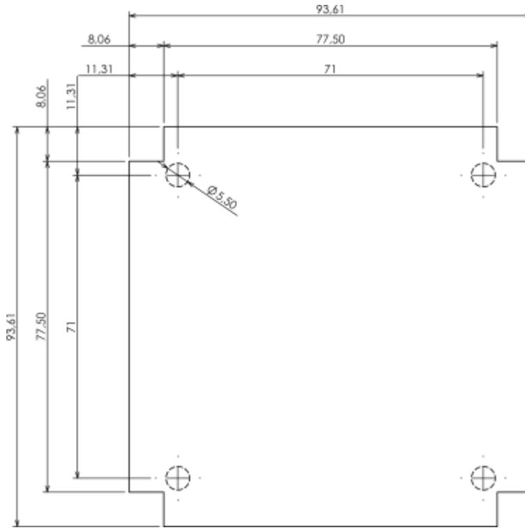
Die gestrichelte Linie zeigt die Umriss des Stecksockels unter der Leiterplatte
