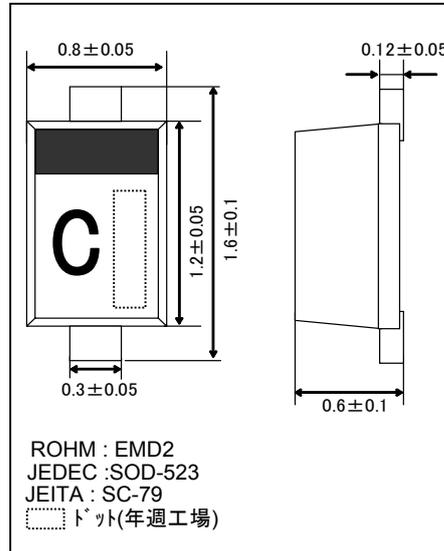
●ランド寸法図 (Unit : mm)
