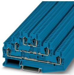
多层接线端子，标称工作电压: 500 V，额定电流: 20 A，连接量: 6，接线方式: 回拉式弹簧连接，第1, 2和第3层，额定接线容量: 2.5 mm<sup>2</sup>，横截面: 0.08 mm<sup>2</sup> - 4 mm<sup>2</sup>，安装方式: NS 35/7,5, NS 35/15，颜色: 蓝色
