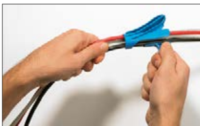
Insérez un ou plusieurs câbles dans l'outil.
