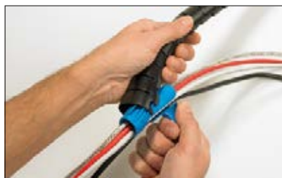
Placez l'extrémité de la gaine dans l'outil.
