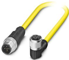
传感器/执行器电缆，5-位置，PVC，黄色，插头 直头 M12，编码: A，与 孔式 弯头 M12，编码: A，电缆长度: 0.5 m
