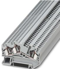
直通式接线端子，标称工作电压: 800 V，额定电流: 32 A，连接量: 3，接线方式: 回拉式弹簧连接，第一层，额定接线容量: 4 mm<sup>2</sup>，横截面: 0.08 mm<sup>2</sup> - 6 mm<sup>2</sup>，安装方式: NS 35/7.5，NS 35/15，颜色: 灰色
