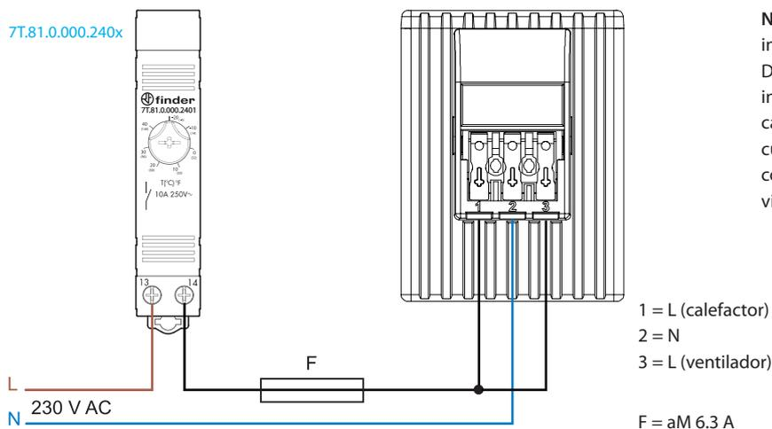
**NOTA:** Bornes (L) separados para la alimentación independiente de calefactor y ventilador. Dependiendo de la aplicación específica, el instalador puede conectarlo de forma que el calefactor sea controlado por el termostato de cuadro y el ventilador esté funcionando constantemente (aunque esto último reducirá la vida de los componentes significativamente).
