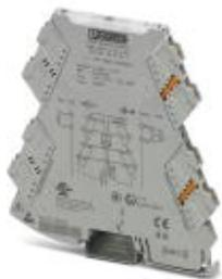
Amplificador de separación de 3 vías con técnica de conexión enchufable para separación galvánica de señales analógicas. Señal de entrada: 4 ... 20 mA, señal de salida: 0 ... 10 V, técnica de conexión push-in
