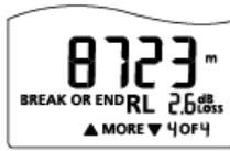
La perte de réflexion de la fibre (RL) est de 2,6 dB.
