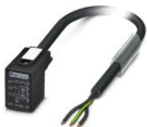
センサ/アクチュエータケーブル, 3-極, PUR ハロゲンフリー, 黒-灰RAL 7021, 片側フリー, 上 バルブプラグ B ( 10 mm ), あり LED 1点, 接続は Zダイオード, ケーブル長: 10 m
