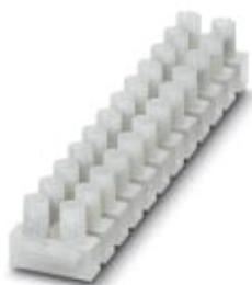
ポリアミド製欧州型端子ストリップ、単線および断面積1~10 mm<sup>2</sup>の棒端子付き撚線を接続
