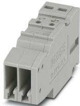
COMBI插座，标称工作电压: 500 V，额定电流: 24 A，连接量: 2，位数: 2，接线方式: 直插式连接，第一层，额定接线容量: 2.5 mm<sup>2</sup>，横截面: 0.14 mm<sup>2</sup> - 4 mm<sup>2</sup>，颜色: 灰色
