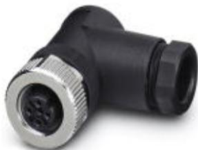
Steckverbinder, Universal, 5-polig, Buchse gewinkelt M12, A-kodiert, Schraubanschluss, Rändelmaterial: Zinkdruckguss, vernickelt, Kabelverschraubung Pg9, Kabelaußendurchmesser 6 mm ... 8 mm
