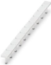
插针式标记条，接头，白色，未标记，适用的打印机：CMS-P1-PLOTTER，安装方式：插拔式，适用的模块宽度：7.5 mm，标签数：10，文本框高度：4 mm，文本框宽度：6 mm
