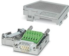
D-SUB连接器，9位，针式连接器，两个进线 $< 35^\circ$ ，总线系统：CAN、SUCONET K1、K2 (MOELLER)、SBUS (Saia)、J-BUS (Merlin Gerin)，引脚分配：2, 3, 4, 5, 7, 9两个螺钉接线端子
