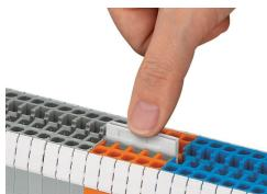
Insérer les peignes de pontage jusqu'en butée (en appuyant alternativement à gauche puis à droite et ainsi de suite)!
