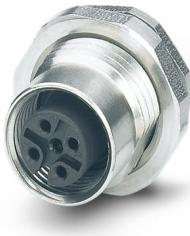
设备连接器 板后安装，4-位置，孔式，直头，M12，编码: A，板后安装，Pg9，波峰焊，根据RoHS II指令（不含豁免条款6c，即铅含量<0.1%），本产品预计自2026年第一季度起实现无铅化；如需提前获得无铅替代品，可应要求提供
