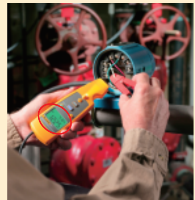
ループの切断無く4-20mA信号をクランプで測定
