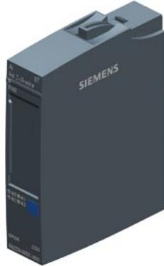
SIMATIC ET 200SP AI 4xI 2/4 line TX 模块基于 6ES7134-6GD01-0BA1 带防腐蚀涂层，-40 - +70°C，OT4 带 ST1/2 (+85°C 持续 10 分钟)，模拟式输入模块，适用于 A0 类型的基座单元，A1，颜色代码 CC03，模块诊断，16 位，+/-0.3%
