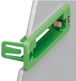
面板安装框架，额定横截面: 2.5 mm<sup>2</sup>，颜色: 绿色，电位数: 12，行数: 1，位数: 12，连接量: 12，产品系列: IC-DFR，针距: 5.08 mm，包装类型: 纸箱包装，此安装框架仅可与IC 2,5/-STGF-5,08组合使用
