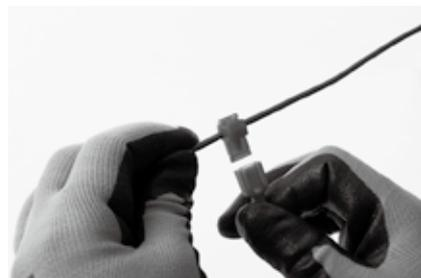
3. 予め電線を取り付けた分岐用ターミナルを挿入します。
