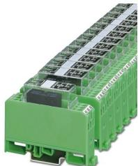
リレーモジュール、ソルダインタイプミニチュアスイッティングリレー、接点（AgNi）：中～高負荷、ダブルA2接続、1c接点、入力電圧230 V AC/DC
