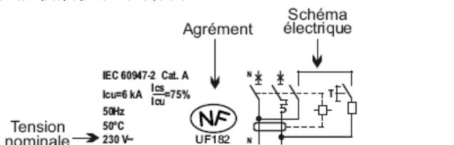
. Les bornes amont et aval du pôle neutre sont repérées par un « N » moulé à proximité des têtes de vis.
