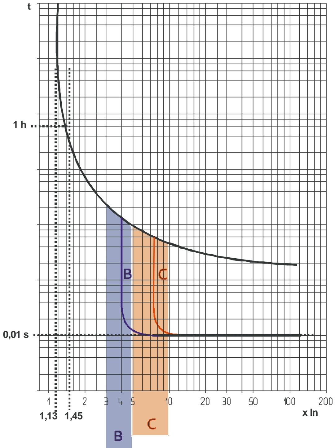
Déclenchement thermique à température ambiante = 30°C
