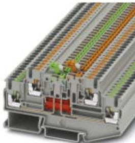
Messertrennklemme, Anschlussart: Push-in-Anschluss, Querschnitt: 0,14 mm<sup>2</sup> - 4 mm<sup>2</sup>, AWG: 26 - 12, Nennstrom: 16 A, Nennspannung: 400 V, Länge: 92,4 mm, Breite: 5,2 mm, Farbe: grau, Montage: NS 35/7,5, NS 35/15
