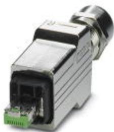
Connecteur Push-Pull (version 14), en zinc moulé sous pression, avec raccord de connecteur RJ45 à 8 pôles, avec raccordement autodénudant IDC, pour conducteurs de 1 et 7 fils AWG 23...22, pour diamètre de câble entre 5,5 mm et 10 mm
