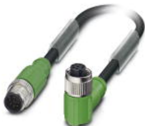
センサ/アクチュエータケーブル, 8-極, PUR ハロゲンフリー, 黒-灰RAL 7021, シールド対応, プラグ ストレー ト M12, Aコーディング, 上 ソケット アングル M12, Aコーディング, ケーブル長: 3 m
