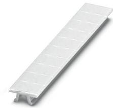
端子台マーキング、ラベリング、白、マーキングあり、ラベリング可能 : CMS-P1-PLOTTER、横方向に印字: U, V, W, N, GND, U, V, W, N, GND、取付けタイプ: スナップ式、端子台幅 : 6.2 mm、印字エリア: 6,15 x 10,5 mm、個別ラベル数: 10
