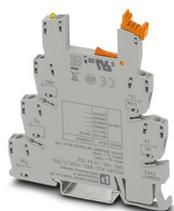
6.2 mmのねじ式PLCベース端子台、リレーまたはソリッドステートリレーなし、内部アンプ回路、弱信号源に適した補助電源、12 V DCの定格入力電圧
