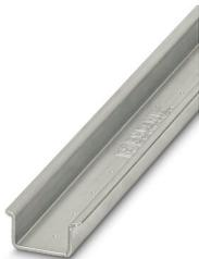
DINレール、取付け穴なし、EN 60715準拠、部材: スチール、亜鉛メッキ加工され不動態化処理、標準プロファイル 2.3 mm、色: 銀、10本パック (20 m)
