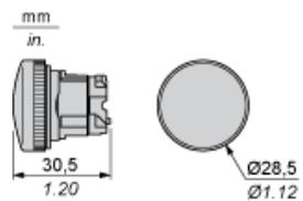
Schalttafel Ausschnitte für Drucktaster, Schalter und Meldeleuchten (fertige Bohrungen, installationsbereit)
