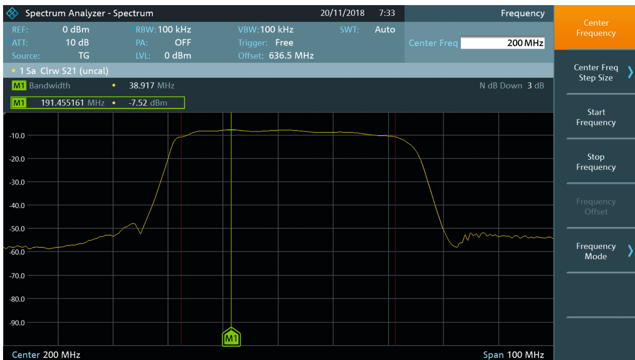
R&S®FPC1500: cadena de señal medida por un generador de tracking que incluye mezcladores, filtros y amplificadores
