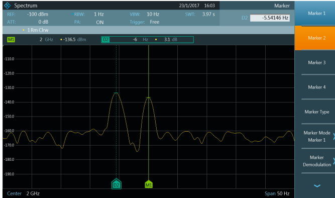
R&S®FPC-B22: alta sensibilidad con preamplificador interno
