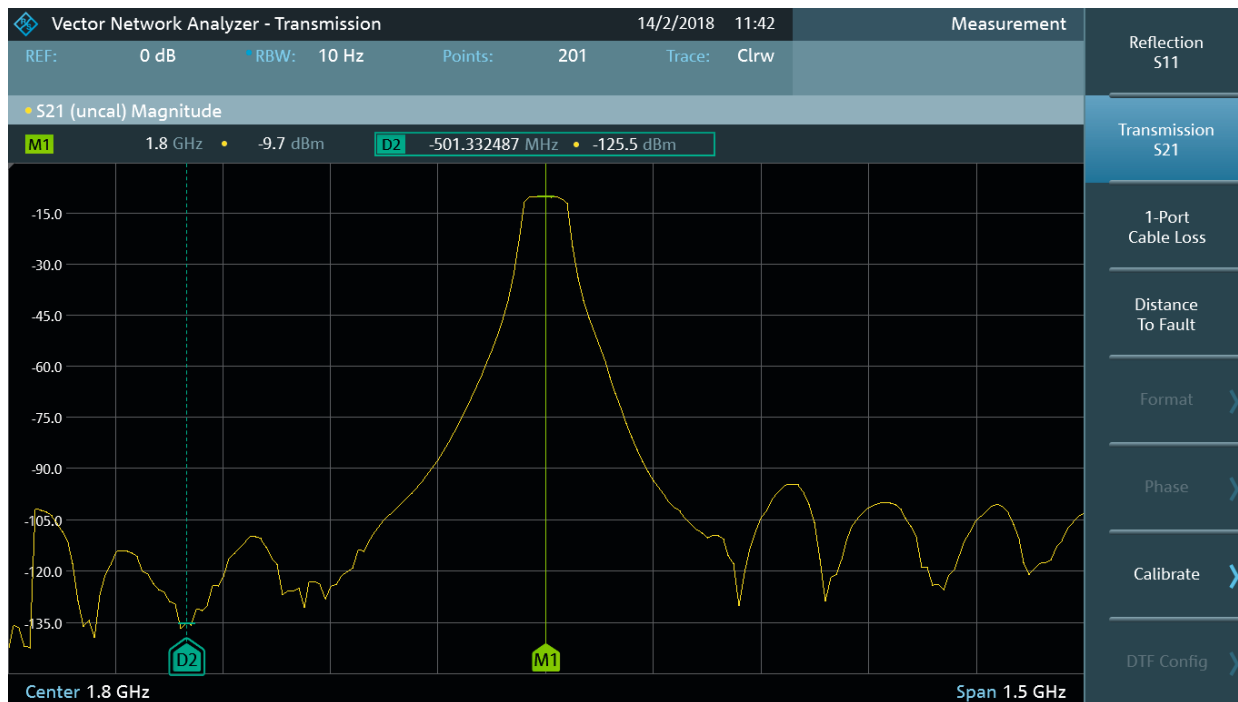
R&S®FPC1500: medición de transmisión escalar S_{21} con la opción R&S®FPC-K42
