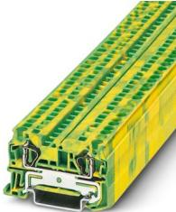
弹簧接地端子，连接量: 2，接线方式: 回拉式弹簧连接，第一层，横截面: 0.08 mm<sup>2</sup> - 6 mm<sup>2</sup>，安装方式: NS 35/7,5，NS 35/15，颜色: 黄绿相间
