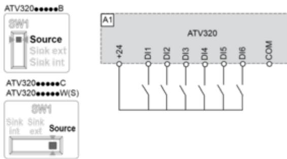
开关 SW1 设置为“Source”位置，将使用外部电源给 DI 供电。
