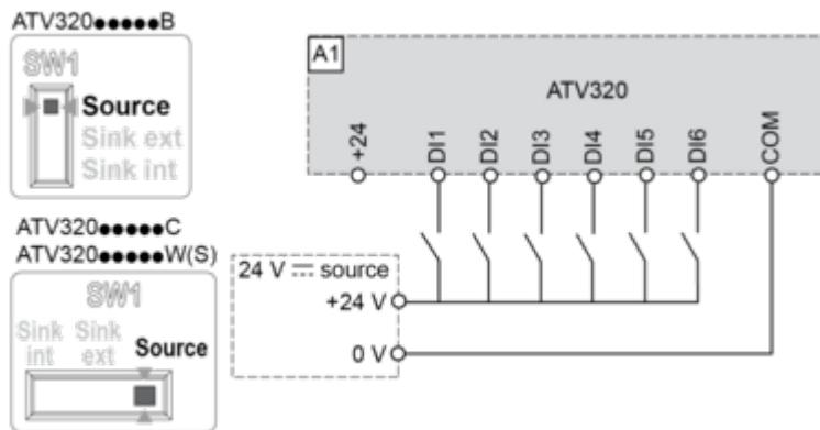
开关 SW1 设置为“Sink Int”位置，将使用输出电源给 DI 供电。
