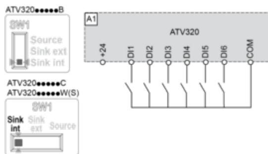
开关 SW1 设置为“Sink Ext”位置，将使用外部电源给 DI 供电。
