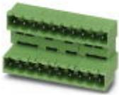
Leiterplattengrundleiste, Nennstrom: 10 A, Bemessungsspannung (III/2): 320 V, Polzahl: 10, Rastermaß: 5,08 mm, Farbe: grün, Kontaktoberfläche: Zinn, Montage: Wellenlöten, Der Artikel ist zu unterschiedlichen Polzahlen anreihbar! Bei Kombination mit MVSTB- oder FKCV-Steckerteilen ist jeweils ein MVSTBW- (bzw. FKCVW-) und ein MVSTBR-Stecker (bzw. FKCVR-) zu verwenden. Kombination mit TMSTBP-Steckerteilen ist nicht möglich!
