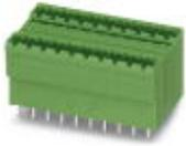
Leiterplattengrundleiste, Nennstrom: 10 A, Bemessungsspannung (III/2): 320 V, Polzahl: 10, Rastermaß: 5,08 mm, Farbe: grün, Kontaktoberfläche: Zinn, Montage: Wellenlöten, Bei Kombination mit MVSTB- oder FKCV-Steckerteilen ist jeweils ein MVSTBW- (bzw. FKCVW-) und ein MVSTBR-Stecker (bzw. FKCVR-) zu verwenden. Kombination mit TMSTBP-Steckerteilen ist nicht möglich!
