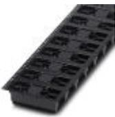
Leiterplattengrundleiste, Nennstrom: 12 A, Bemessungsspannung (III/2): 320 V, Polzahl: 10, Rastermaß: 5,08 mm, Farbe: schwarz, Kontaktfläche: Zinn, Montage: THR-Löten, Anwenderinformationen und Designempfehlungen zur Through Hole Reflow Technologie finden Sie unter 'Downloads'
