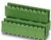
Leiterplattengrundleiste, Nennstrom: 10 A, Bemessungsspannung (III/2): 320 V, Polzahl: 10, Rastermaß: 5,08 mm, Farbe: grün, Kontaktoberfläche: Zinn, Montage: Wellenlöten, Anreihbar! Befestigungsflansch: Art.-Nr. 1836477, 1836480. Bei Kombination mit MVSTB- oder FKCV-Steckerteilen ist jeweils ein MVSTBW- (bzw. FKCVW-) und ein MVSTBR-Stecker (bzw. FKCVR-) zu verwenden. Kombination mit TMSTBP-Steckerteilen ist nicht möglich!
