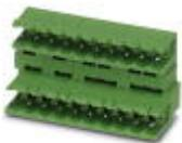
Leiterplattengrundleiste, Nennstrom: 10 A, Bemessungsspannung (III/2): 320 V, Polzahl: 10, Rastermaß: 5,08 mm, Farbe: grün, Kontaktoberfläche: Zinn, Montage: Wellenlöten, Anreihbar! Befestigungsflansch: Art.-Nr. 1736771, 1736768. Bei Kombination mit MVSTB- oder FKCV-Steckerteilen ist jeweils ein MVSTBW- (bzw. FKCVW-) und ein MVSTBR-Stecker (bzw. FKCVR-) zu verwenden. Kombination mit TMSTBP-Steckerteilen ist nicht möglich!
