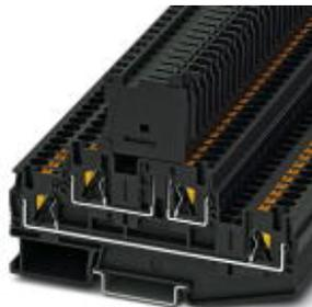
Sicherungsreihenklemme, Anschlussart: Push-in-Anschluss, Querschnitt: 0,2 mm<sup>2</sup>- 6 mm<sup>2</sup>, AWG: 24 - 10, Nennstrom: 6,3 A, Nennspannung: 500 V, Breite: 6,2 mm, Sicherungstyp: G / 5 x 20, Art der Sicherung: Glas / Keramik / ..., Montageart: NS 35/7,5, NS 35/15, Farbe: schwarz
