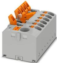
功能配电块，基座端子分支中配备馈入和分断刀闸，通过螺丝刀或手动方式断开连接，标称工作电压: 400 V，额定电流: 20 A，负载触点，接线方式: 直插式连接，额定接线容量: 2.5 mm<sup>2</sup>，接线容量: 0.14 mm<sup>2</sup> - 4 mm<sup>2</sup>，线路触点，接线方式: 直插式连接，额定接线容量: 6 mm<sup>2</sup>，接线容量: 0.5 mm<sup>2</sup> - 10 mm<sup>2</sup>，安装: 用于卡接在DIN导轨适配器上，直接安装，带法兰，自由悬挂，颜色: 灰色
