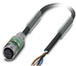
センサ/アクチュエータケーブル, 4-極, PUR ハロゲンフリー, 黒-灰RAL 7021, 片側フリー, 上 ソケット ストレート M12, Aコーディング, あり LED 2点, ケーブル長: 10 m
