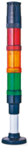
Artikel-Nr.: ECO40-Q31 Farben: rot-orange-grün Funktion: LED Dauerlicht, Summer Dauer- oder Pulston Nennspannung: 24 V AC/DC Montageart: Rohrmontage (100 mm Rohrlänge)
