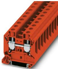
直通式接线端子，标称工作电压: 1000 V，额定电流: 76 A，连接量: 2，接线方式: 螺钉连接，额定接线容量: 16 mm<sup>2</sup>，横截面: 1.5 mm<sup>2</sup> - 25 mm<sup>2</sup>，安装方式: NS 35/7,5, NS 35/15，颜色: 红色
