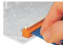
Insertion directe pour raccorder les con-
