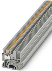
微型直通式接线端子，标称工作电压: 500 V，额定电流: 17.5 A，连接量: 2，接线方式: 直插式连接，第一层，额定接线容量:  $1.5 \text{ mm}^2$ ，横截面:  $0.14 \text{ mm}^2 - 1.5 \text{ mm}^2$ ，安装方式: NS 15，颜色: 灰色
