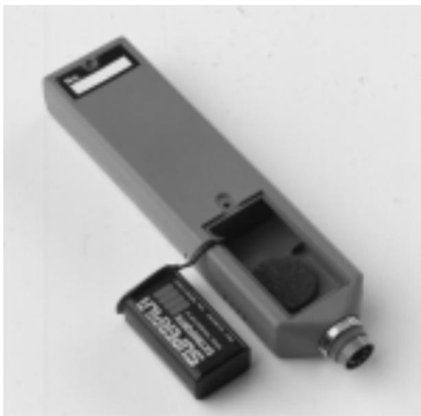
sostituire la batteria esaurita con altra carica.
