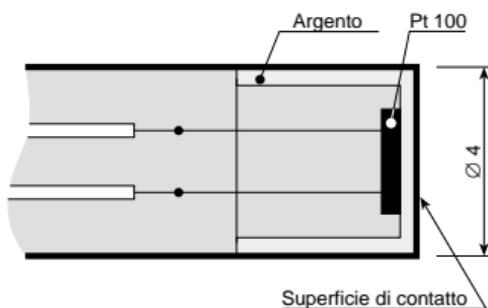
La sonda ed il connettore sono assemblate secondo il disegno.
