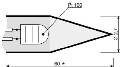
\* Lunghezza minima di penetrazione per eseguire correttamente la misura
