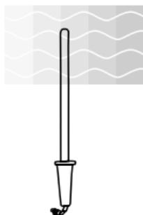
Nella misura a penetrazione la punta della sonda deve entrare per minimo 60 mm, il sensore è inserito all'estremità della sonda. Nella misura di temperatura su blocchi surgelati è conveniente praticare con un eventuale attrezzo meccanico una cavità in cui successivamente inserire la sonda a punta.
