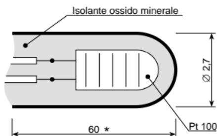
\* Lunghezza minima d'immersione per eseguire correttamente la misura
