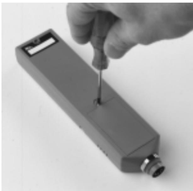
Per sostituire la batteria svitare la vite con testa a croce dello sportellino vano batteria,
