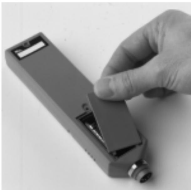
Sostituire la batteria con strumento spento.
