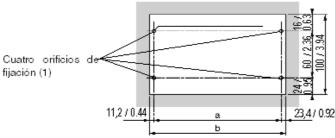
(1) El diámetro de los orificios de fijación deberá admitir el uso de tornillos M4, M5, M6 y UNC #6.
